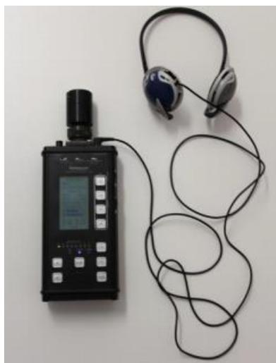
Figura 1 -Bat detector modello D1000X
