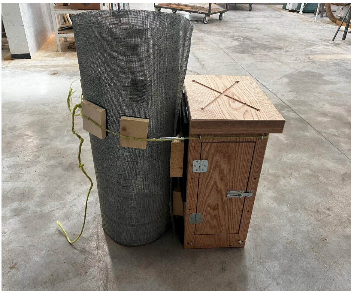
Figura 3 – Prototipo di Wood Mould Box realizzato da AFOR Umbria e sistema di aggancio (ottobre 2023)
